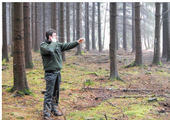
Azalera basimetrikoaren neurketa errelaskopio batekin (Beauraing, Belgika).
